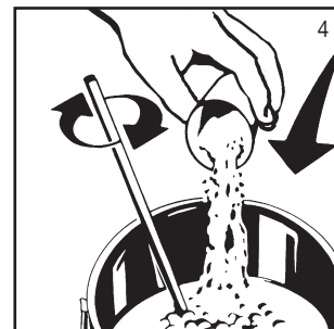
4: Einen Behälter mit klarem, handwarmem Frischwasser füllen und 25 ml Hagerty 5* Shampoo (Teppichreiniger) pro Liter Wasser beifügen und gut mischen. Vor Gebrauch Flasche gut schütteln. Inhalt des Frischwassertanks: 9 Liter.
